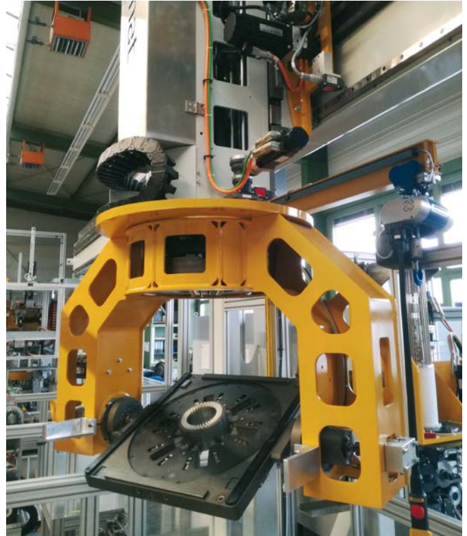
Bei der Stator-Fertigungsanlage von Risomat wird das Werkstück mitsamt dem Werkstückträger vom Portalkran zwischen den verschiedenen Bearbeitungsplätzen transportiert.
